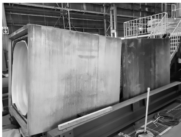
写真4 鉛直6°屈曲製管状況 (□1400×1400)
