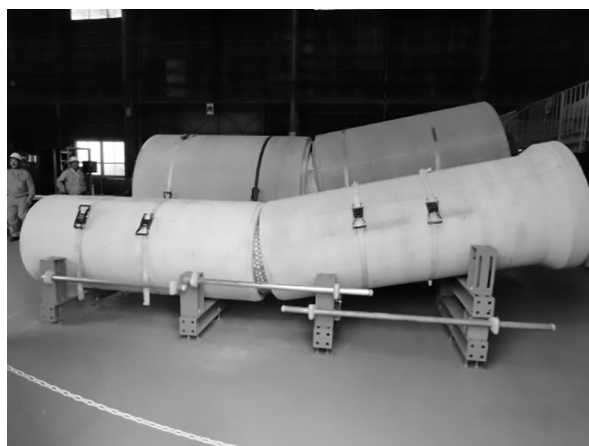
写真3 鉛直12°屈曲製管状況 (HP800、HP1500)
