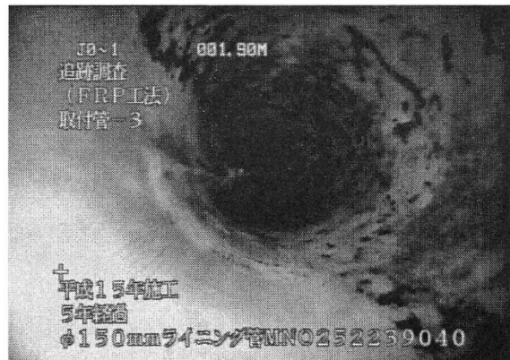
ライニング材の未硬化による座屈
