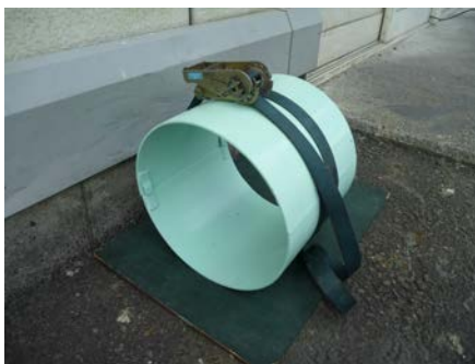
図－5 管体状テストピース採取用治具
