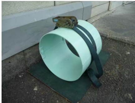
図－3 管体状テストピース採取用治具
