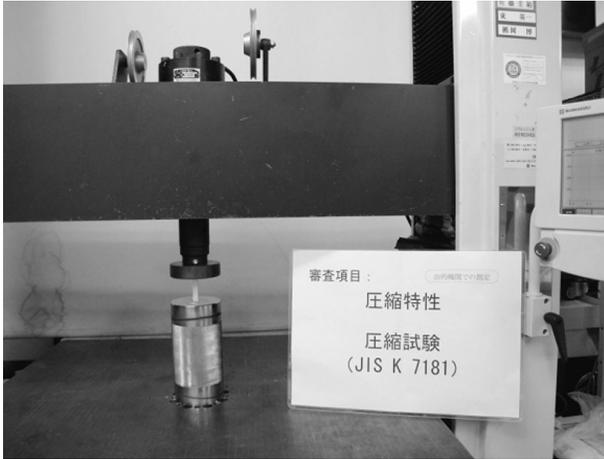
写真-4 圧縮試験状況
