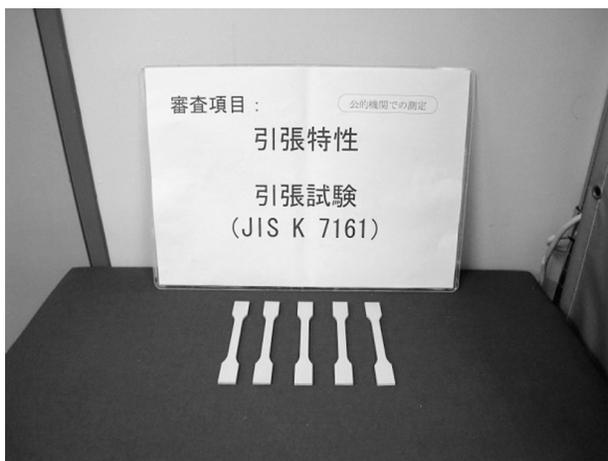
写真-1 引張試験片
