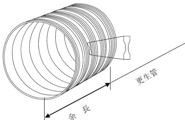
図2 スチール部材の切出し試験片
