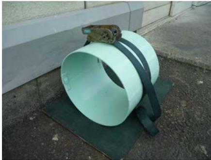
図－6 管体状テストピース採取用治具
