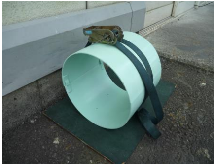
図－6 管体状テストピース採取用治具
